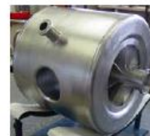
Cavités spoke (CNRS Orsay) 352 MHz - \beta = 0,15 et 0,35
