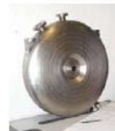
Cavité ré-entrante (Legnaro) 352 MHz - \beta \geq 0,1
