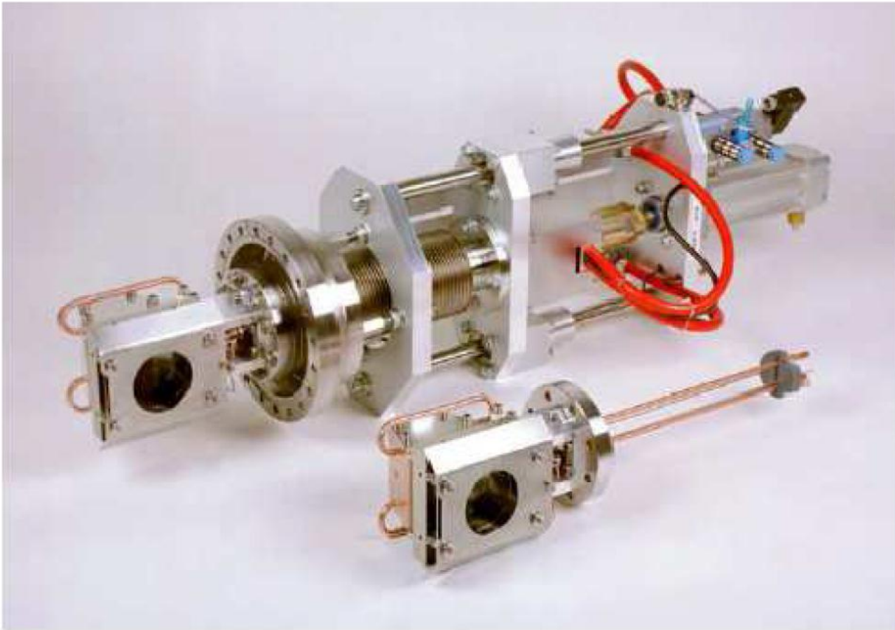
Cage de Faraday et bloc d'arrêt de 25 KW. Linac de GSI. (Bride 150 mm 2 )
